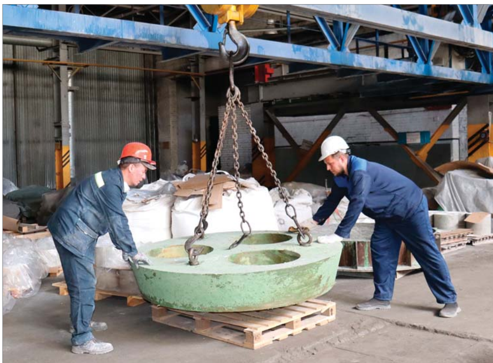
Выгрузка сводового изделия из печи.
