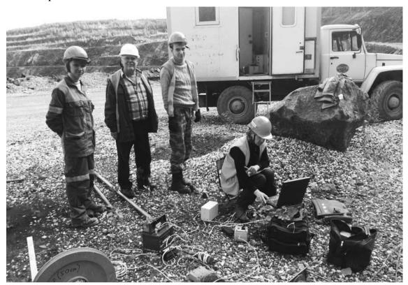
— За лето мы надеемся выполнить большой объем полевых исследований. В июне планируется выезд полевого отряда в Режевской и Ивдельский районы Свердловской области на геофизическое исследование скважин, включающее проведение стандартного электрического комплекса, магнитометрический каротаж, изучение акустической эмиссии, термометрию, инклинометрию. Данное обследование необходимо для заверения рудных проявлений, оконтуренных наземными геофизическими методами.
