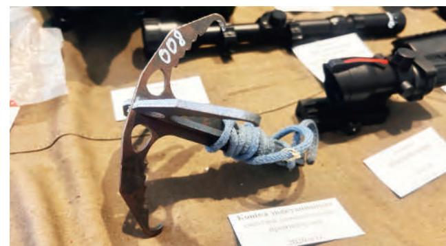
Крюк «Кошка» предназначен для эвакуации раненого. В нынешних условиях к раненому не всегда возможно близко подобраться, поэтому «кошку» цепляют на карабин и вытягивают раненого из зоны поражения
