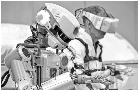
Управлять «Теледройдом» будет человек в специальном костюме-экзоскелете. Кроме того, у новой машины есть и система голосового управления, которая работает с помощью ИИ.
