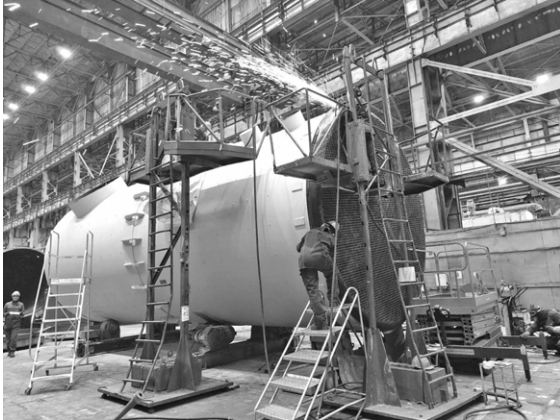
Изделие длиной 10,9 метра, диаметром 4,3 метра и весом 141 тонна — это самый большой конденсатор в истории завода.
