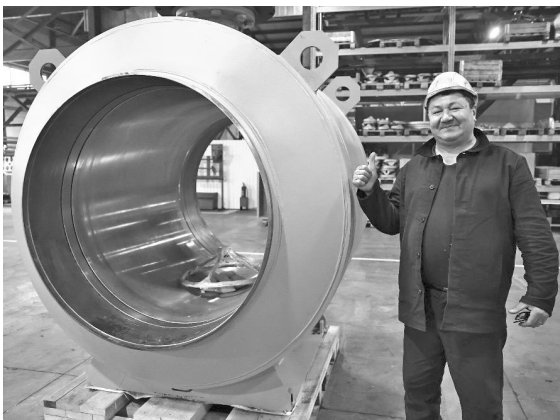
Масса нового крана — 7,85 тонны, а максимальное избыточное давление, при котором изделие может использоваться безопасно, выше, чем у аналогов.
