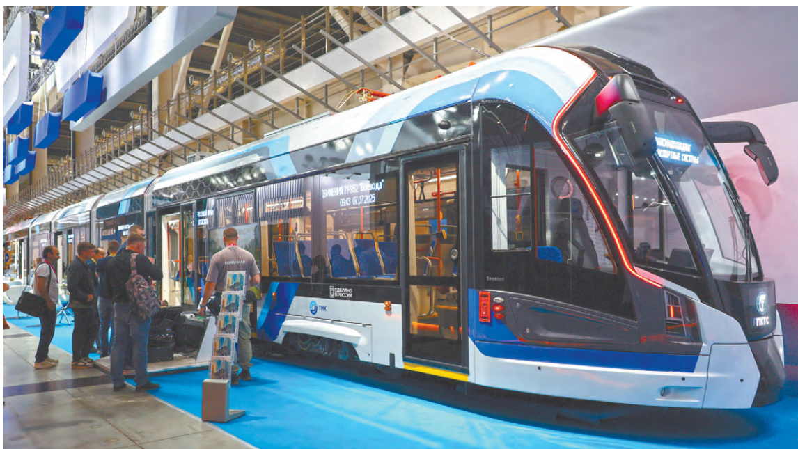
«Воевода» имеет две кабины и двери по обе стороны вагона.
