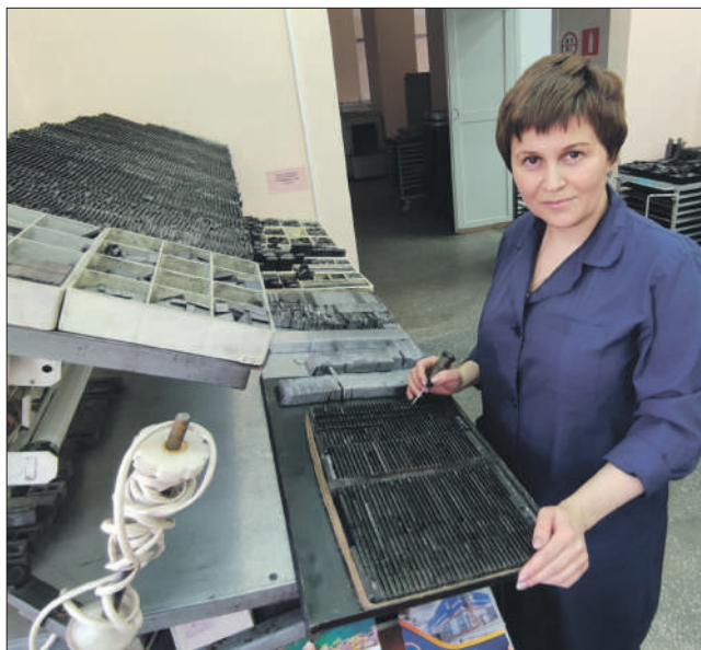
Наборщик Ирина Учайкина вручную вставляет печатные и пробельные элементы в печатную форму, поправляя их шилом
