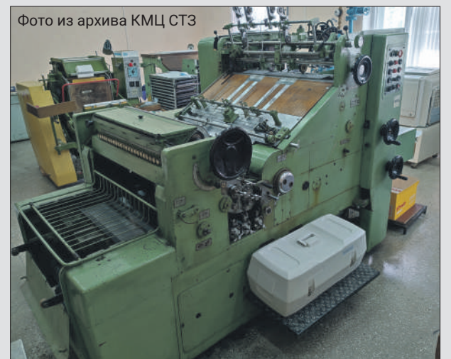
Машина-самонаклад 1990 года выпуска печатает с печатных форм, в том числе большие форматы и тиражи, например, 140 журналов по 100 листов
