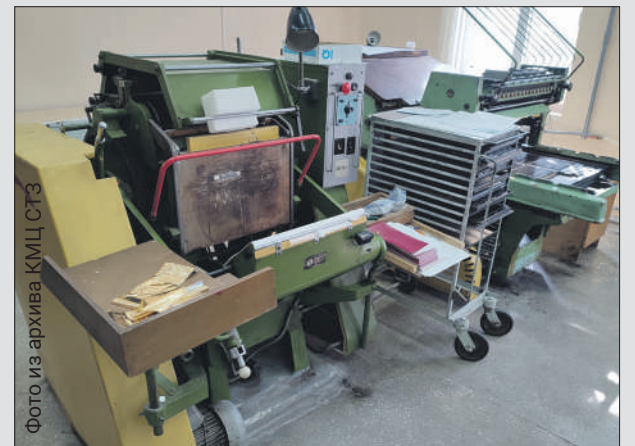
На «золотом» прессе выполняется тиснение золотой фольгой при температуре +180 градусов надписей к удостоверениям, свидетельствам. Позади стоит печатная машина 1990 года выпуска
