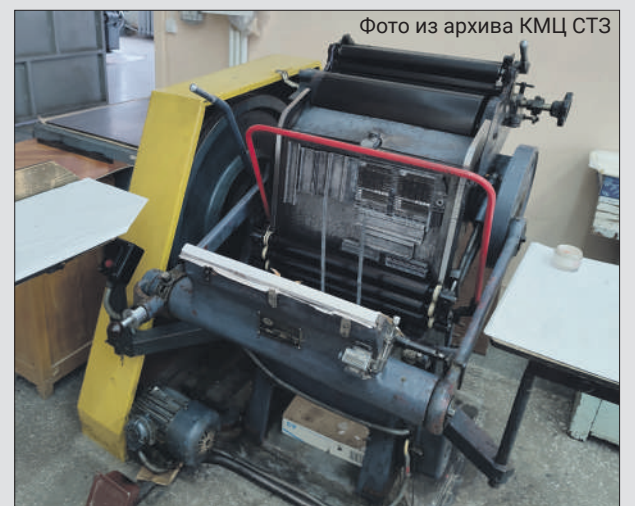
Тигельная машина 1967 года выпуска печатает на картоне, ватмане, например, бирки для цехов завода
