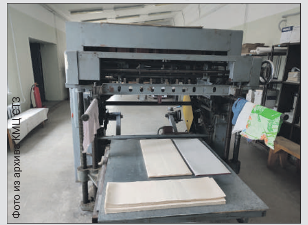
Бумага приходит в типографию в рулонах, на бумагоразмоточной машине 1990 года выпуска она разматывается и режется по формату
