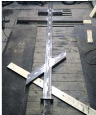
■ Накупольный крест перед облицовкой
