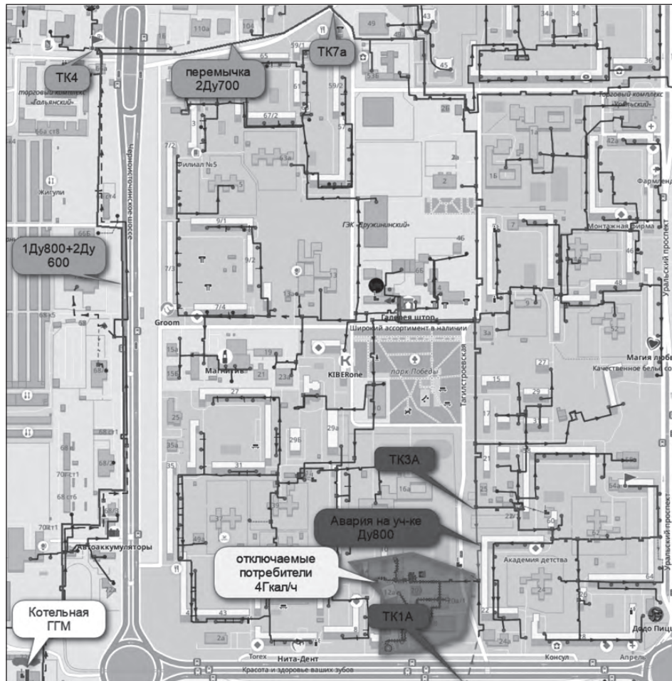
РИСУНОК 1. Смоделированная аварийная ситуация. Альтернативный путь движения теплоносителя
