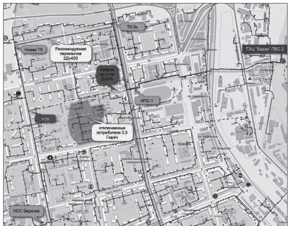
РИСУНОК 3. Смоделированная аварийная ситуация. Альтернативный путь движения теплоносителя
