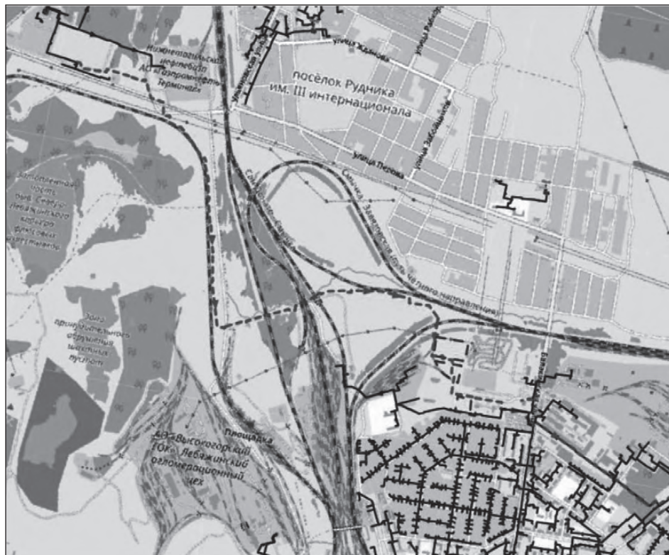
РИСУНОК 21. Схема отключаемого участка от котельной ПСХ до НСС-6
