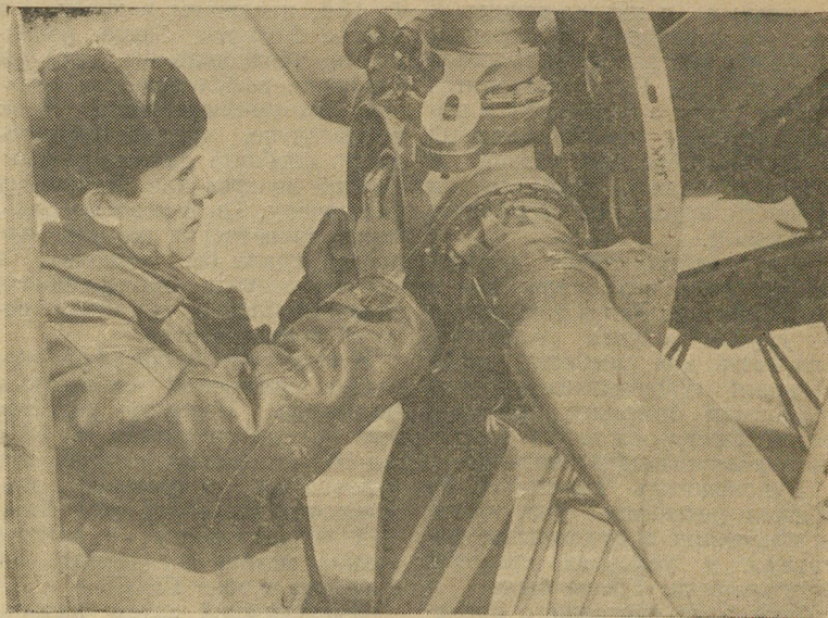
НА СНИМКЕ: техник-бригадир А. Г. Фокин за осмотром втулки воздушного винта. Фото Л. ЕФИМОВА.
