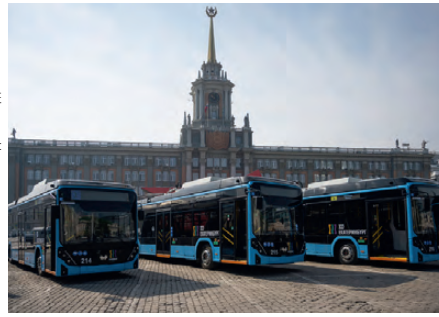
В мае Екатеринбург получил 10 первых троллейбусов, произведенных холдингом «Белкоммунмаш». Все они оснащены системой удлиненного автономного хода, что позволит использовать их даже в тех районах города, которые не оборудованы контактной сетью
