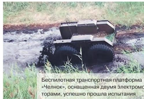
Беспилотная транспортная платформа «Челнок», оснащенная двумя электромоторами, успешно прошла испытания
