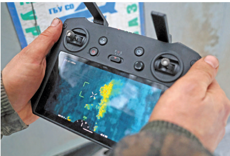
Подземный пожар виден на экране тепловизора.
