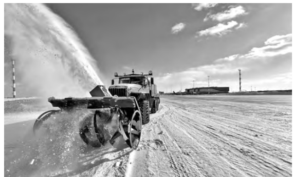
Новая подметально-продувочная машина относится к линейке уборочной техники нового поколения и позволяет очищать аэродром от грязи, пыли и мусора, снега и наледи, удалять резиновые, битумные, масляные и другие загрязнения.
