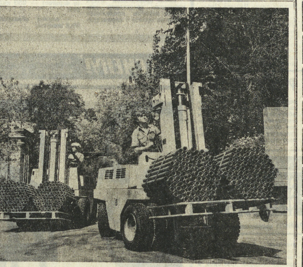
ВОЛГОГРАД. Производство Волгоградского производственного объединения тракторных деталей и нормалей идет все ускоренными темпами. На предприятии большое внимание уделяется совершенствованию системы пакетных перевозок. Так, пружины горючей навески для тракторов отгружаются потребителям пакетами по 700 килограммов. Весомое преимущество этой системы — сохранение продукции при транспортировке, на 23—30 процентов сокращается себестоимость переработки грузов, вдвое сокращаются простои транспорта.
