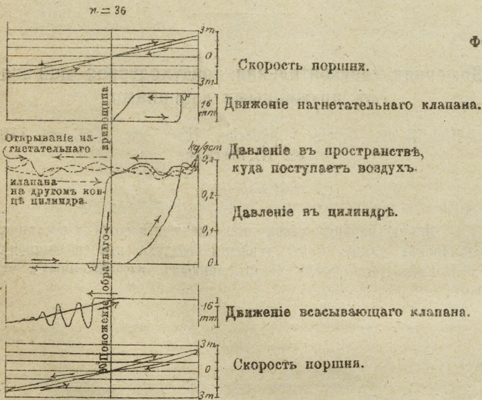
Сжатие воздуха, движения клапанов и поршня в связи движением цапфы кривошипа.
