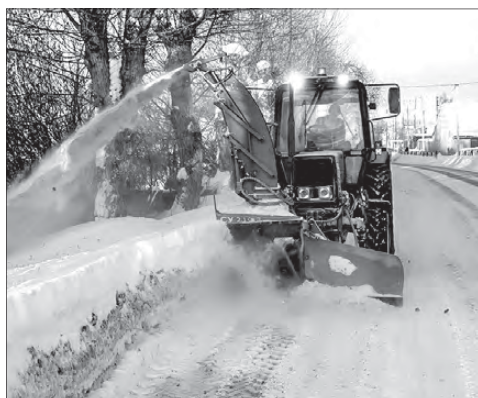
В северной и южной части города в этом году подрядчики активно используют шнекороторный снегоотбрасыватель, он значительно увеличивает скорость работы
