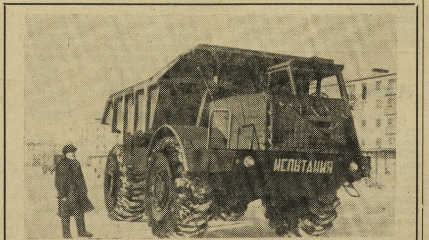
ЛЕНИНГРАДСКАЯ ОБЛАСТЬ. На рудниках Бокситогорского района Ленинградской области проходит государственные испытания самосвал Могилевского автомобильного завода имени Кирова «МоЗ-522А». Главное достоинство этой машины в том, что с грузом 18—20 тонн она свободно преодолевает труднопроходимые места. Самосвалу не страшны ни снежная целина, ни распутица на грунтовых дорогах.
