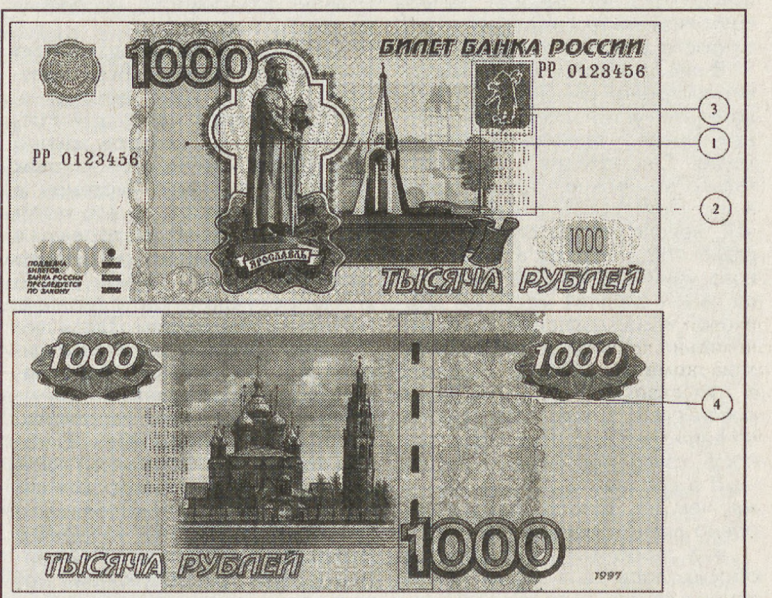
Вот они, новые ловушки для фальшивомонетчиков: 1. Скрытые радужные полосы (на всех банкнотах); 2. Микроперфорация (100, 500 и 1000 рублей); 3. Герб, выполненный цветопеременной краской (только 1000 рублей); 4. Ныряющая металлизированная нить (на всех банкнотах).
