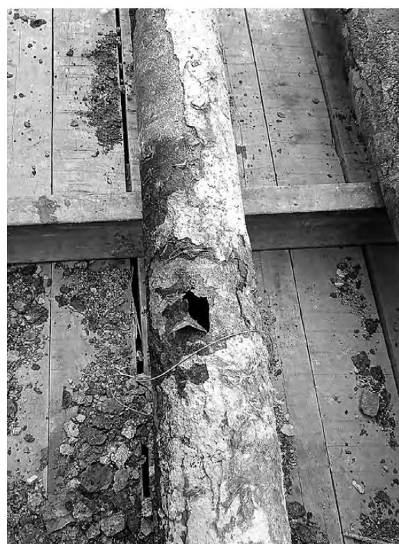
Ликвидация аварии у дома №104 на Ленинградском проспекте. Вот так выглядят трубы, которые прослужили много лет.
