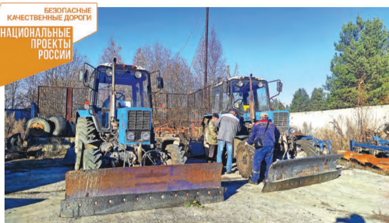
На тракторы устанавливаются снежные отвалы.
