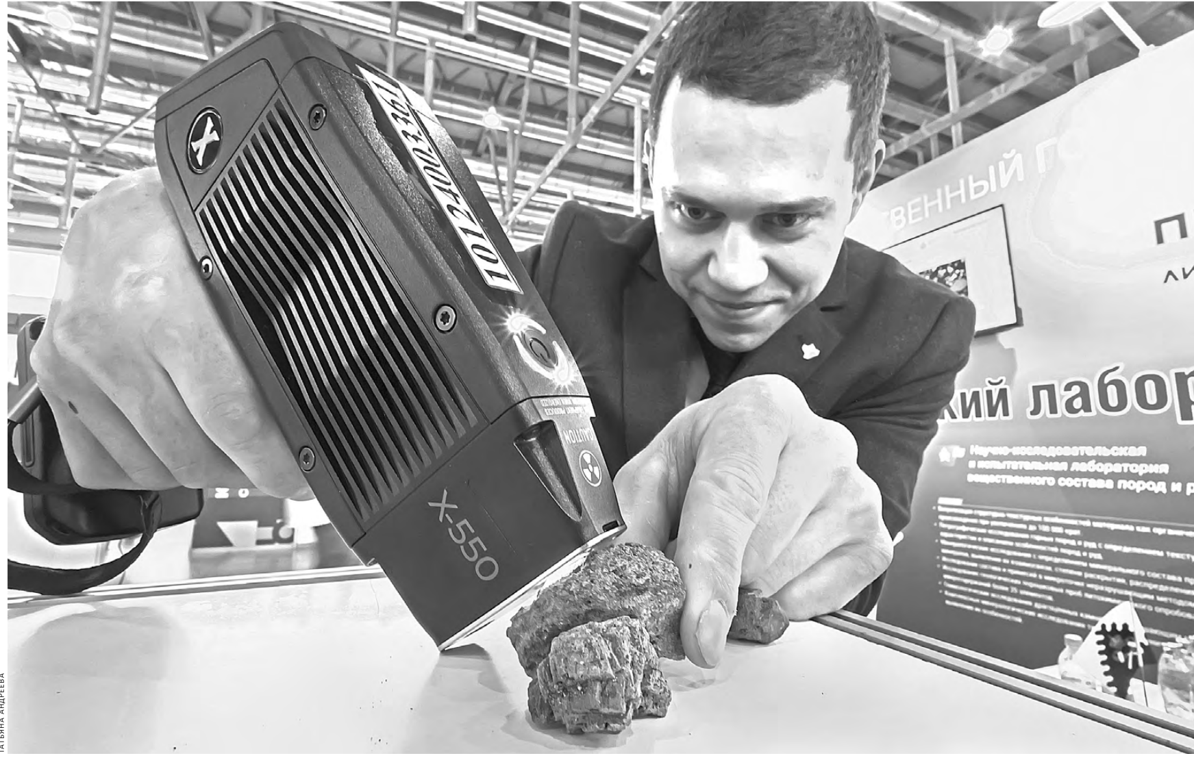
Сергей Завьялов показывает, как с помощью современного прибора за минуту определить состав руды.
