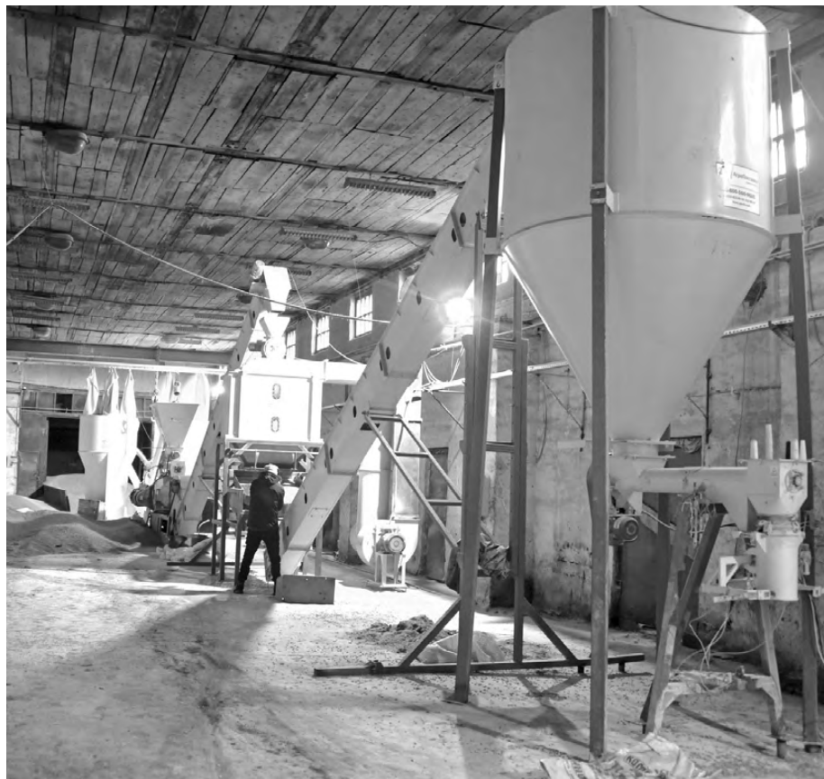
Линия гранулированных комбикормов в Нижнем Катараче мощностью 12 тонн в сутки окупится за пять лет.
