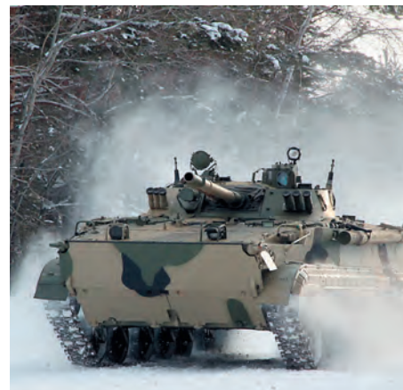
Новый комплекс для БМП-3 по-прежнему обеспечивает защиту от моноблочных гранат и ПТУР с любого направления обстрела, пробивающих до 500 мм стальной брони
