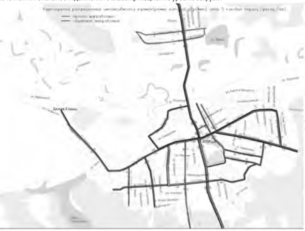
Рисунок 7. Картограмма распределения транспортных потоков по улично-дорожной сети городского округа Талицкого городского округа
