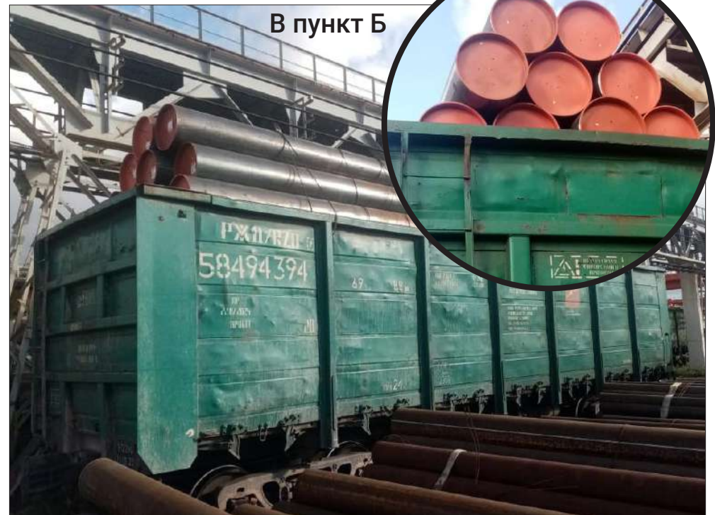
Эксперимент прошёл успешно: вагон с трубами дошёл до потребителя, укладка труб не нарушена
