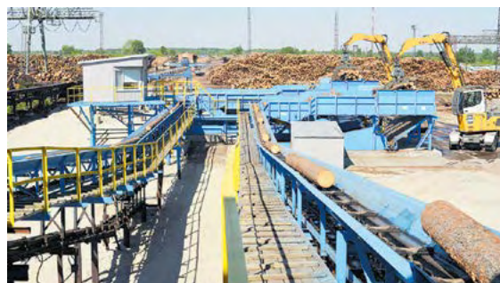
▲ Автоматизированная подача сырья в цех пиломатериалов
