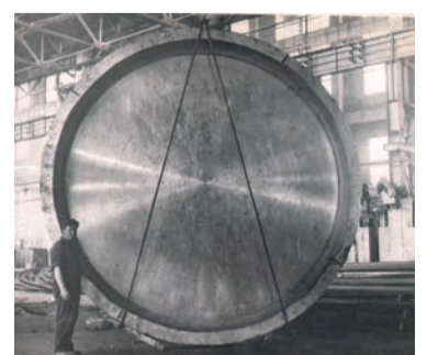
Штамповка днища реактора. 1964 год
