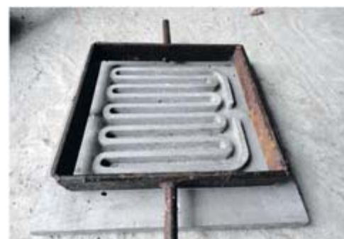
Одна из форм, сделанных отцом, для изготовления керамической электроплитки
