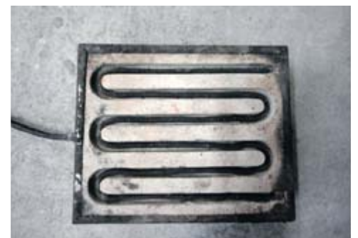
Готовая плитка из огнеупорной смеси для «сифонки»
