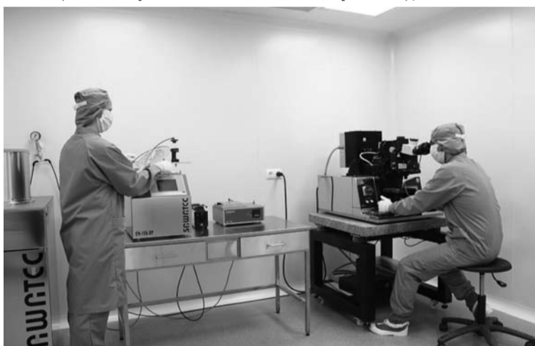
Выполнение литографических процессов по изготовлению магниторезистивных сенсоров в герметизационном модуле чистых помещений ИФМ УрО РАН. 2012 г.
