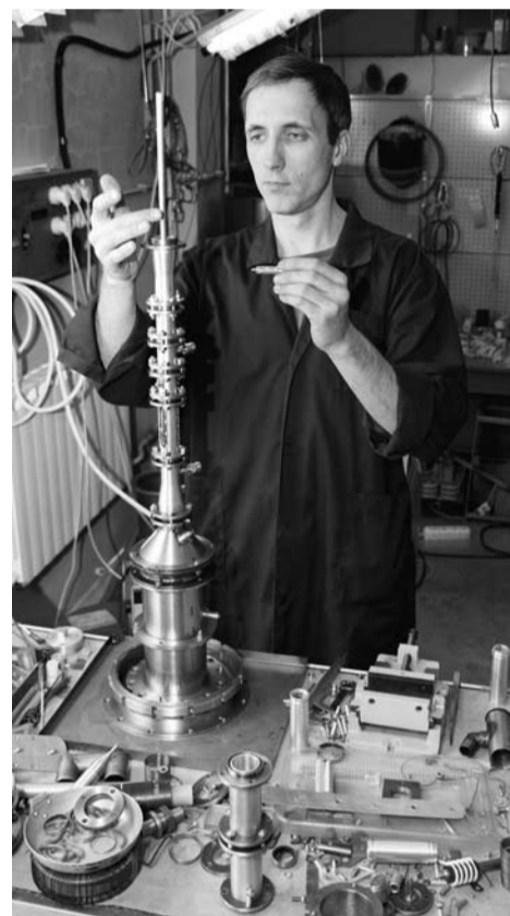
Сборка секции SOS-генератора, действующего на основе эффекта, открытого в Институте электрофизики УрО РАН
