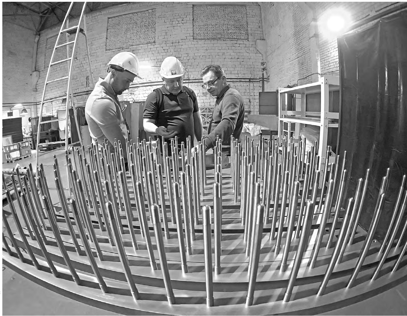
Конструкция РЛС из титана позволит снизить нагрузку на мачту корабля.
