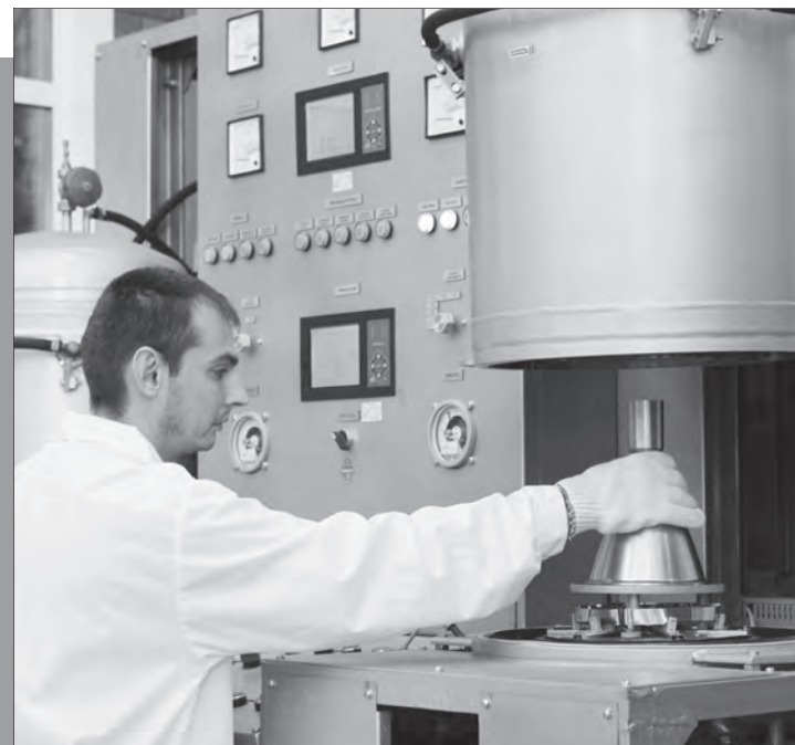
Процесс нанесения покрытий на сопло двигателя
