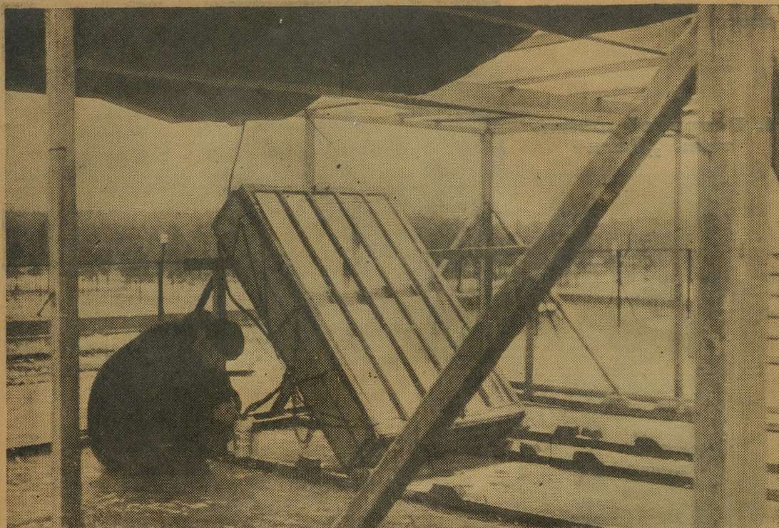
Работы гелиобригады Физико-технич. ин-та по изучению теплопотери различных систем застекления парников. На сн. опытный парник, поставленный на крыше лаборатории
