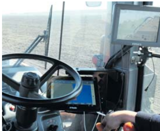
Использование технологии автономного управления трактором по установленной системе параллельного вождения
