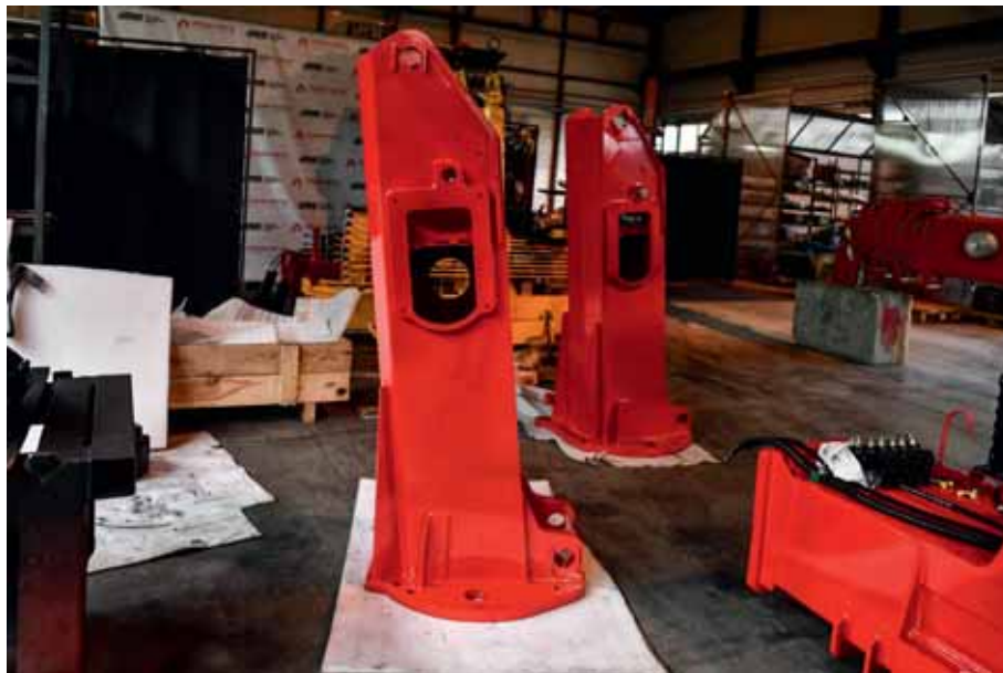
Готовые колонны установят на основание КМУ, к ним крепится телескопическая стрела крана
