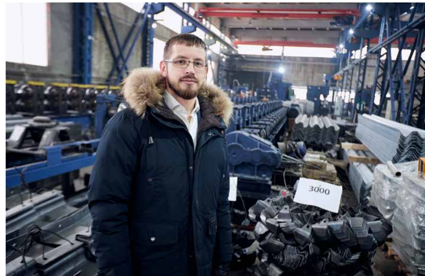
Виталий Копыл показывает заготовки для светоотражающих элементов — на них будет пленка, которую наклеивают исключительно вручную. Один светоотражатель устанавливается на четыре метра ограждения. На такую работу берут только девушек — они аккуратные и готовы к кропотливому труду
