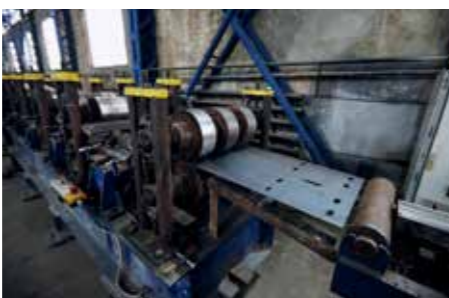
Перед тем как сделать ограждение, листы металла сначала разматывают и пробивают в них отверстия
