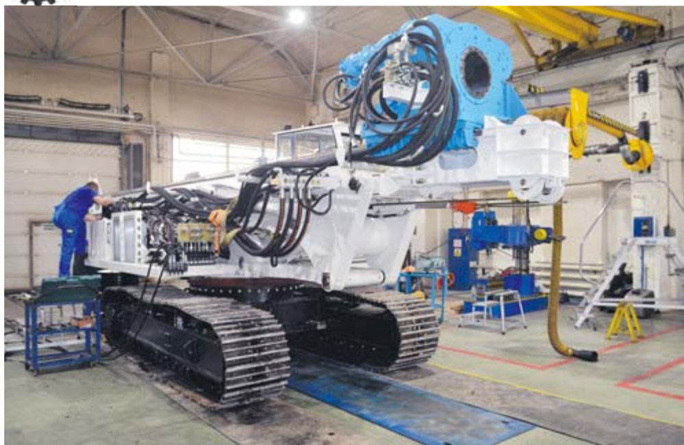
В процессе сборки новая строительная машина СБМ-80
