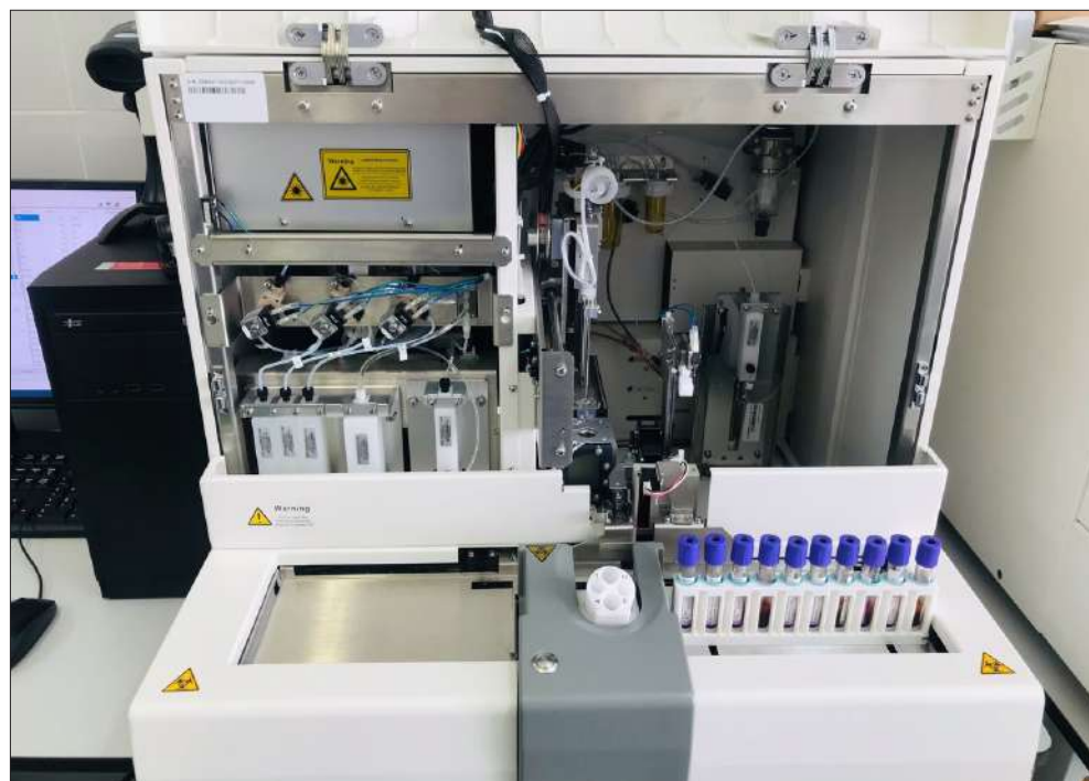
На новом гематологическом анализаторе можно выполнять одно из самых часто назначаемых лабораторных исследований, а встроенные считыватели штрих-кодов позволяют избежать ошибок
