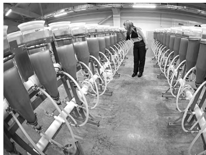
Икра на рыбозаводном заводе вызревает в аппаратах Вейса — их здесь несколько сотен.
