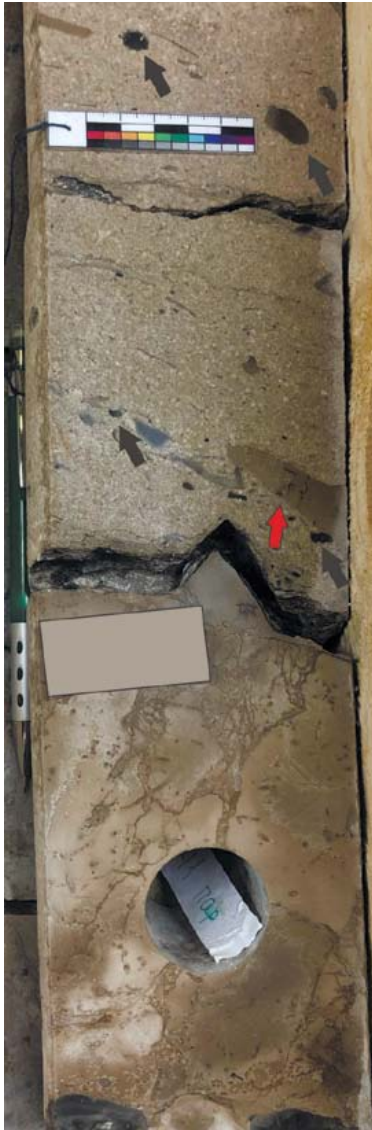
Рис. 9. Выраженная граница между сильно измененным доломитом микрокристаллическим и известняком органогенно-обломочным (ПП5, тип А).
