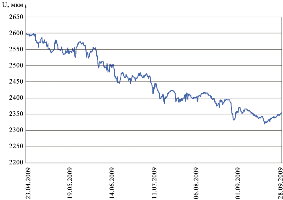
Рис. 3. Графики конвергенции стенок выработки в горизонтальном направлении.
