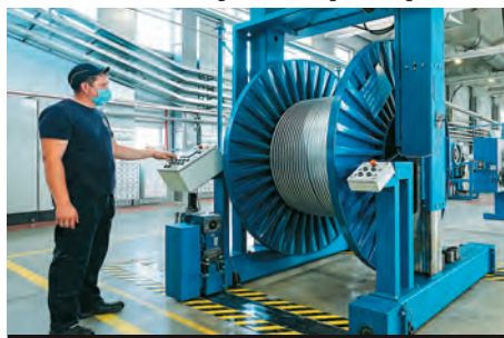
Сейчас на заводе ведется отработка технологии изготовления нефтепогружного кабеля
