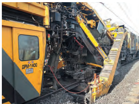
ЩОМ-1400 производства калужского завода «Ремпутьмаш» (входит в состав СТМ) предназначена для очистки щебеночного балласта. Машина состоит из двух секций: добывающе-распределительной и очистной
