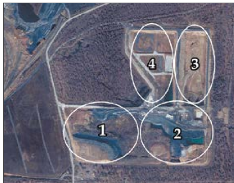
Так выглядят участки под полигон на гугл-картах. На 1 участке поставят производственные мощности (котлован сейчас засыпают). На 2 участке — площадки по утилизации и обезвреживанию отходов. 3 и 4 участки — под хранение отходов.
