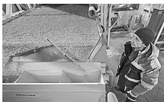
Сортировочная линия может обрабатывать 5 тонн семян в час с наивысшей чистотой по ГОСТу — 99 процентов.
