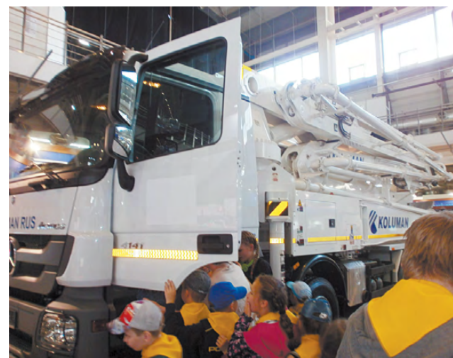
Машина для подачи раствора на верхние этажи.
