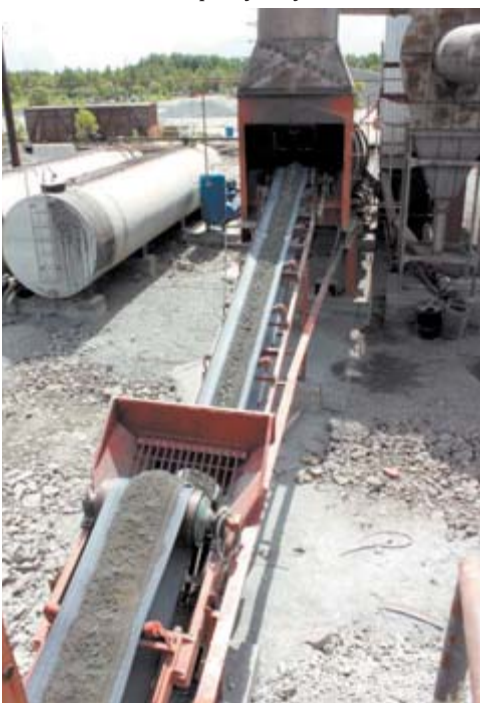
Конвейер доставляет материал непосредственно в сушильный барабан
