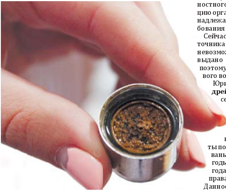
Фильтры на водопроводных кранах забиваются грязью
