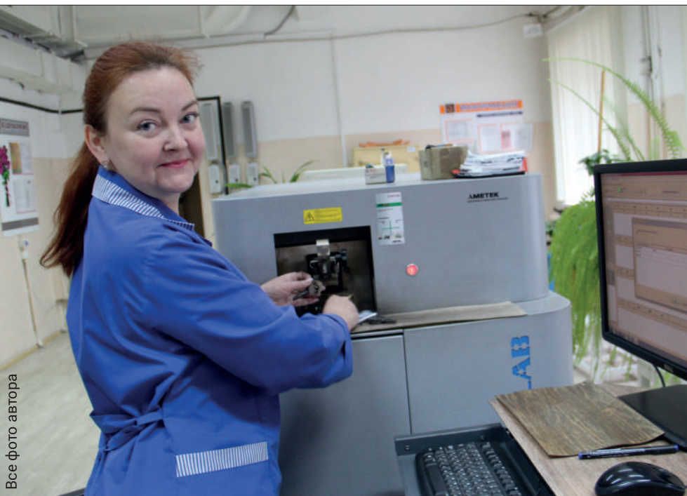
У аппарата, который анализирует состав металла, поступившего из ЭСПЦ, лаборант Светлана Старухина. В основе его работы – спектральный метод, точнее которого ещё ничего не придумано. Аппарат покажет уровень всех химических элементов, которые есть в пробе – углерод, марганец, кремний, мышьяк, свинец, олово и др. Время на анализ – 30 секунд, т.е. в 12 раз быстрее, чем в послевоенные годы, когда анализ занимал 5-6 минут. Пробы из цеха приходят всё так же в патроне по пневмопочте, только размер уже в 10-15 раз меньше тех слитков, что поступали на пробы в 70-е годы. За смену через аппарат проходит
